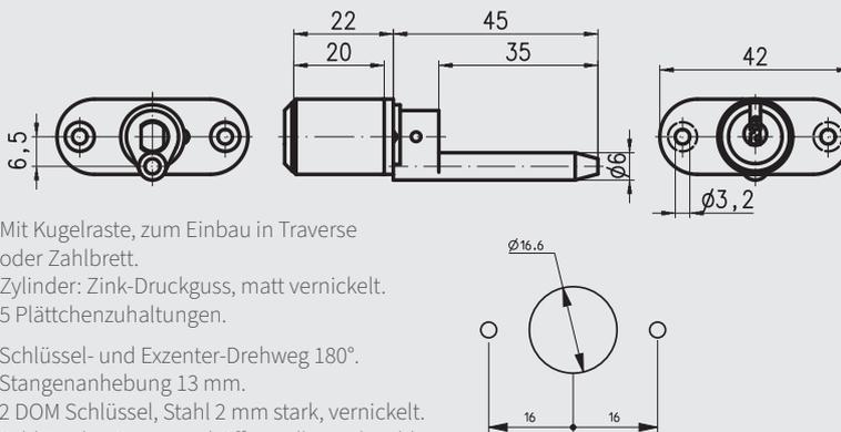
Mit Kugelraste, zum Einbau in Traverse oder Zahlbrett.
