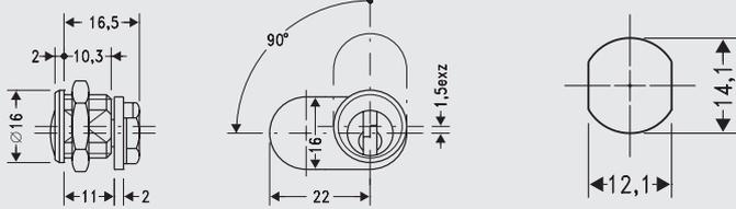
Zylinder: Messing, Struktur Glanznickel
