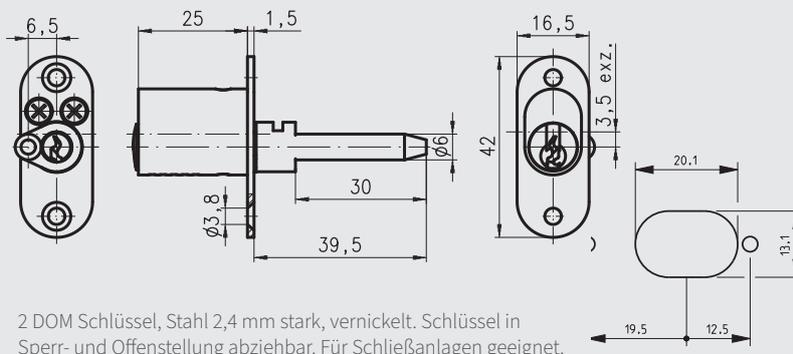
2 DOM Schlüssel, Stahl 2,4 mm stark, vernickelt. Schlüssel in Sperr- und Offenstellung abziehbar. Für Schließanlagen geeignet.
