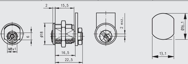
Zylinder: Messing, Struktur Glanznickel
