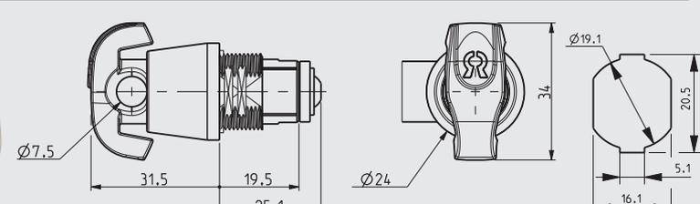
Zylinder: Zink-Druckguss, vernickelt
