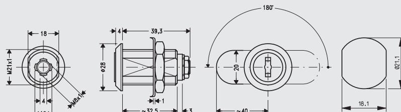
Zylinder: Zink-Druckguss, matt vernickelt
