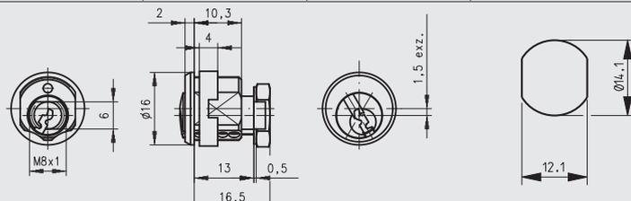
Zylinder: Messing, Struktur Glanznickel
