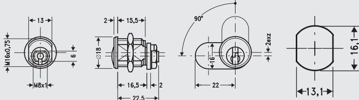
Zylinder: Messing, Struktur Glanznickel
