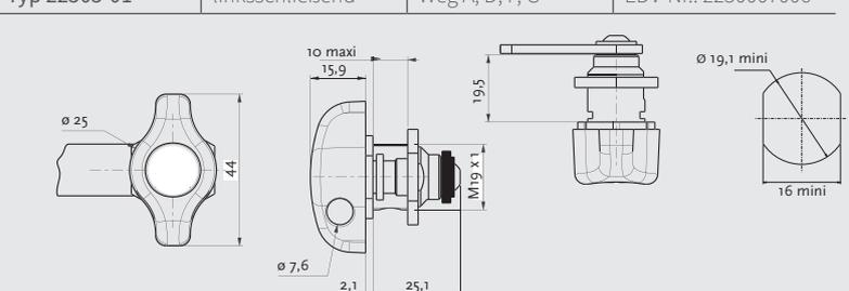
Zylinder: Zink-Druckguss, vernickelt
