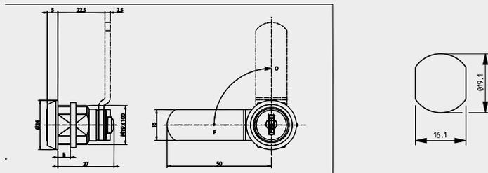
Zylinder: Zink-Druckguss, glanzverchromt
