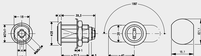
Zylinder: Zink-Druckguss, matt vernickelt
