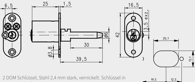
2 DOM Schlüssel, Stahl 2,4 mm stark, vernickelt. Schlüssel in Sperr- und Offenstellung abziehbar. Für Schließanlagen geeignet.
