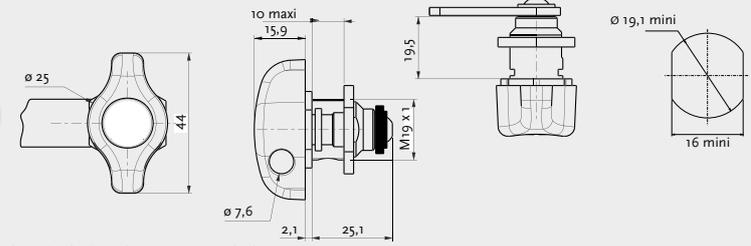
Zylinder: Zink-Druckguss, vernickelt
