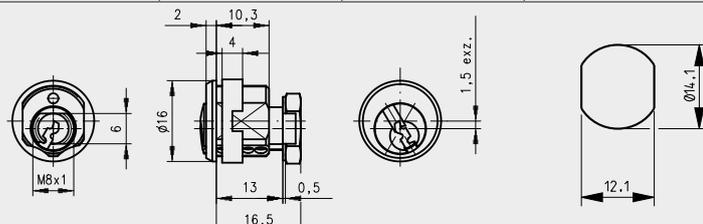
Zylinder: Messing, Struktur Glanznickel
