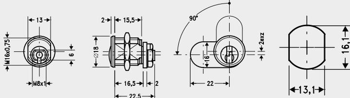
Zylinder: Messing, Struktur Glanznickel
