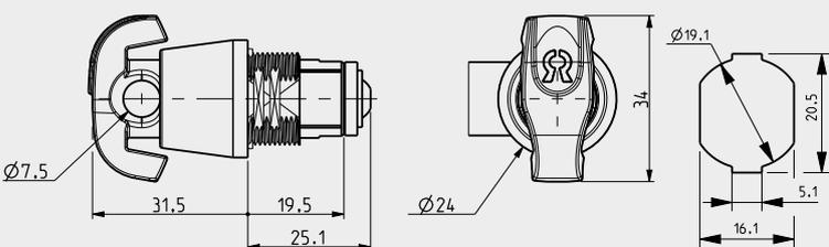
Zylinder: Zink-Druckguss, vernickelt
