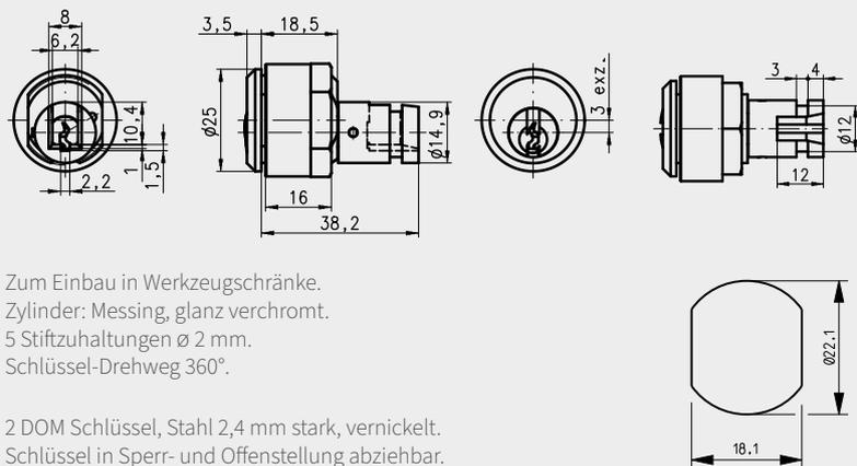
2 DOM Schlüssel, Stahl 2,4 mm stark, vernickelt. Schlüssel in Sperr- und Offenstellung abziehbar. Für Schließanlagen geeignet.
