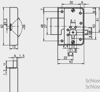
Schlosskasten: Zink-Druckguss, matt vernickelt
