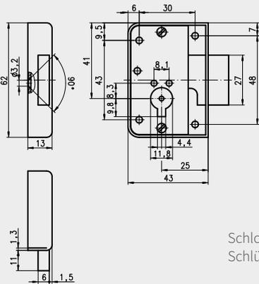
Schlosskasten: Zink-Druckguss, matt vernickelt
