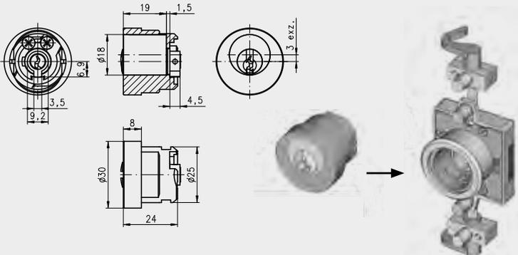
Zylinder: Zink-Druckguss, matt vernickelt.
