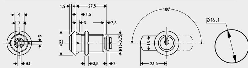
Zylinder: Zink-Druckguss, matt vernickelt
