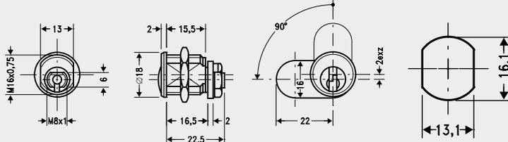
Zylinder: Messing, Struktur Glanznickel
