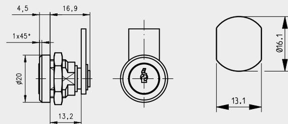
Zylinder: Zink-Druckguss, glanzverchromt
