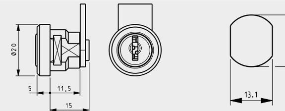
Zylinder: Zink-Druckguss, glanzverchromt
