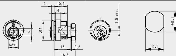
Zylinder: Messing, Struktur Glanznickel
