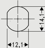
Zylinder: Messing, Struktur Glanznickel
