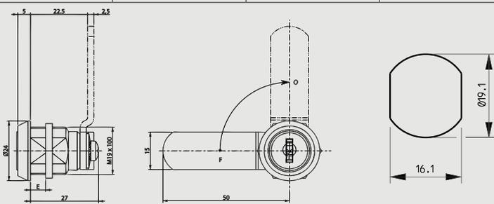
Zylinder: Zink-Druckguss, glanzverchromt
