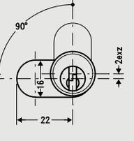
Zylinder: Messing, Struktur Glanznickel
