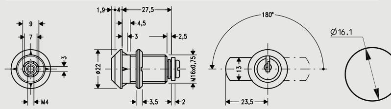
Zylinder: Zink-Druckguss, matt vernickelt
