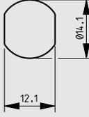
Zylinder: Messing, Struktur Glanznickel
