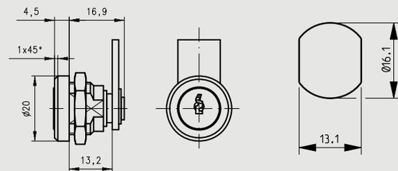
Zylinder: Zink-Druckguss, glanzverchromt
