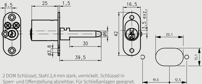
Zum Einbau in Traverse oder Zahlbrett. Zylinder: Messing, matt vernickelt.
