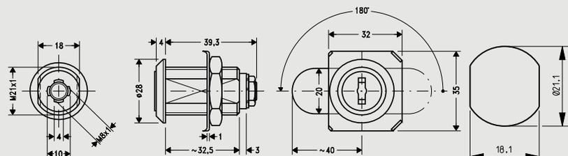
Zylinder: Zink-Druckguss, matt vernickelt
