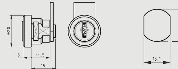
Zylinder: Zink-Druckguss, glanzverchromt
