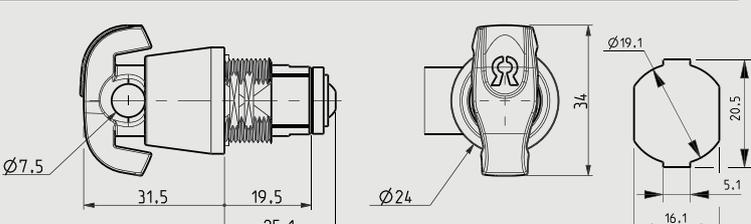
Zylinder: Zink-Druckguss, vernickelt
