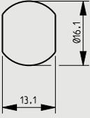
Zylinder: Messing, Struktur Glanznickel
