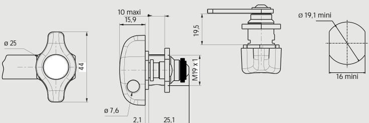
Zylinder: Zink-Druckguss, vernickelt
